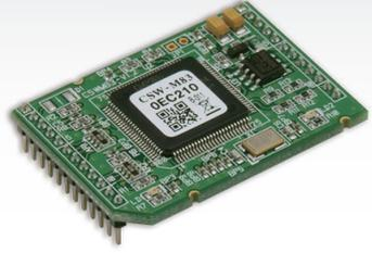
CSW-M83 은 시리얼 장비를 무선랜 (Wireless LAN) 으로 제어 및 관리할 수 있도록 해주는 시리얼 무선랜 변환 모듈 (Embedded Serial to Wireless LAN Module) 입니다. IEEE 802.11b/g 무선 표준에 맞게 설계된 CSW-M83 을 사용자 장비에 시리얼 (UART) 로 연결하면 소프트웨어 변경 없이 간단히 무선랜 네트워크에 연결할 수 있습니다. 따라서 기존 사용자 장비의 통신키리를 확장할 수 있을 뿐만 아니라 유선 작업이 어려운 환경에서도 편리하게 네트워크를 구성할 수 있습니다.
