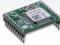
CSE-M53N 은 IPv4 는 물론 이며 , IPv6 기반의 네트워크에 적용 가능한 IPv6 주소 체계를 지원하는 초소형 시리얼 이더넷 모듈 (Serial to Ethernet Module) 입니다 . CSE-M53N 은 원격지에서 시리얼 장비를 제어 및 관리할 수 있도록 네트워크에 연결시켜 주는 변환 기능을 수행합니다 .
