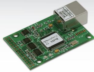
**CIE-M10**은 8개의 디지털 입력포트 (Digital Input Port) 와 8 개의 디지털 출력포트 (Digital Output Port), 1개의 아날로그 입력 포트 (ADC Port) 를 지원하는 원격 I/O 제어 모듈 (Remote I/O Module) 입니다.
