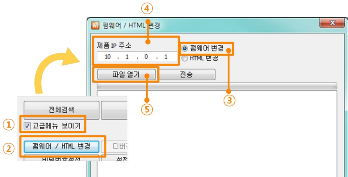
그림 7-1 TFTP 클라이언트 실행 및 전송 준비
