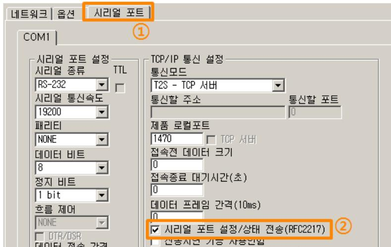
그림 7-3 시리얼 포트 설정/상태 전송 기능 설정
