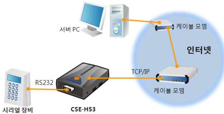
그림 1-3 케이블 모뎀에 적용한 구성
