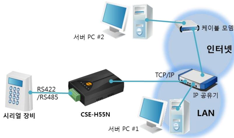
그림 1-4 IP공유기를 이용한 구성 예
