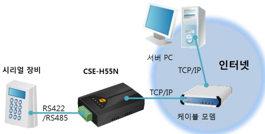
그림 1-3 케이블 모뎀에 적용한 구성
