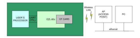
EZL-80c는 ezTCP 제품군중 IEEE802.11b(wireless LAN, 무선랜)를 통한 TCP/IP 통신을 제공하는 소형/모듈형 제품으로 CF 무선랜 카드를 삽입하는 형태입니다.(CF 무선랜 카드는 CF 규격으로 하는 소형 무선랜 카드로서, PCMCIA 무선랜 카드와 동일한 무선랜 통신 기능을 제공합니다.)
