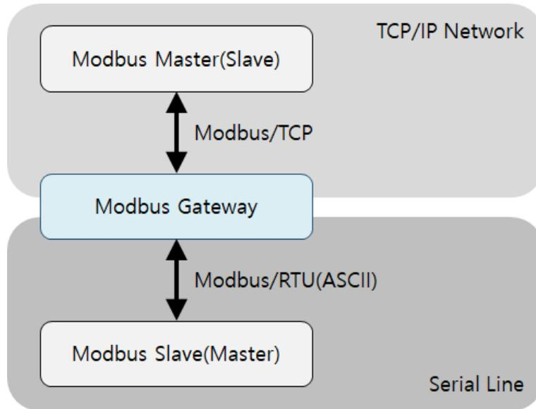
그림 1-1 Modbus Gateway
