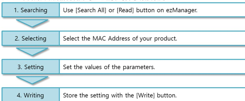
图 3-2 通过LAN的通信设定顺序
