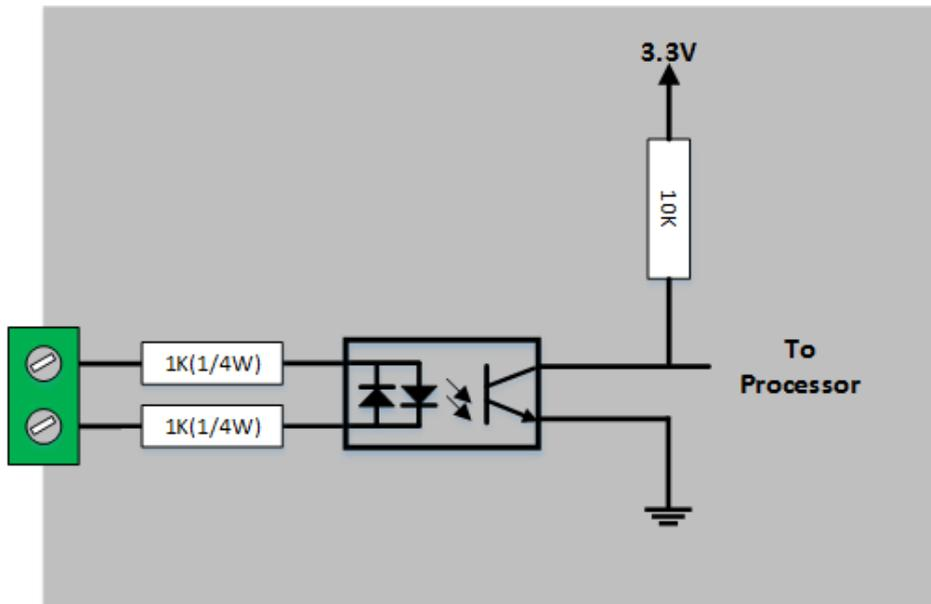
图 1-2 输入端口 电路图
