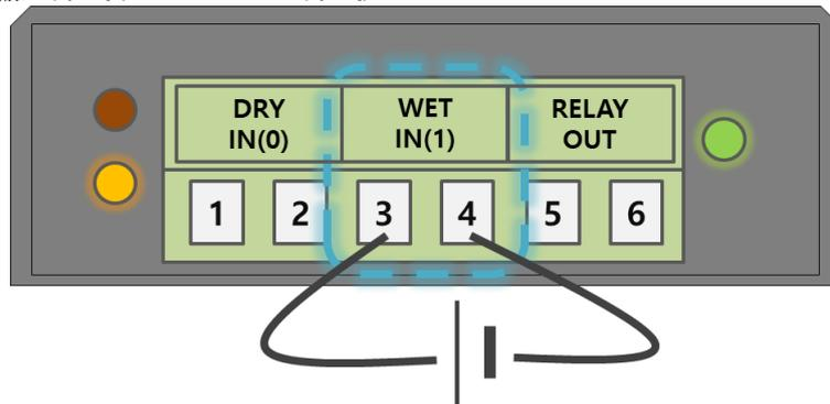
图 1-3 电压输入方式
