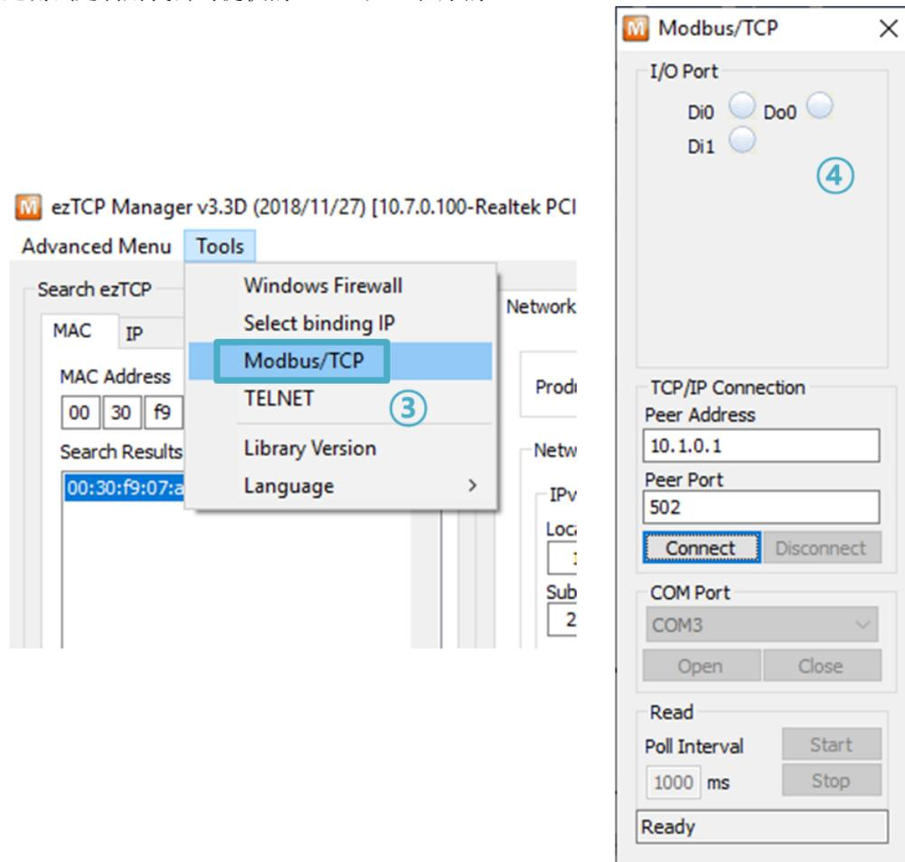
图 2-3 Modbus/TCP通信测试程序
