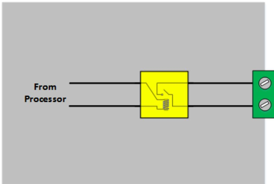
图 1-9 输出端口 电路图
