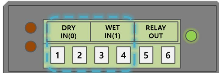
图 1-1 输入端口（正面）
