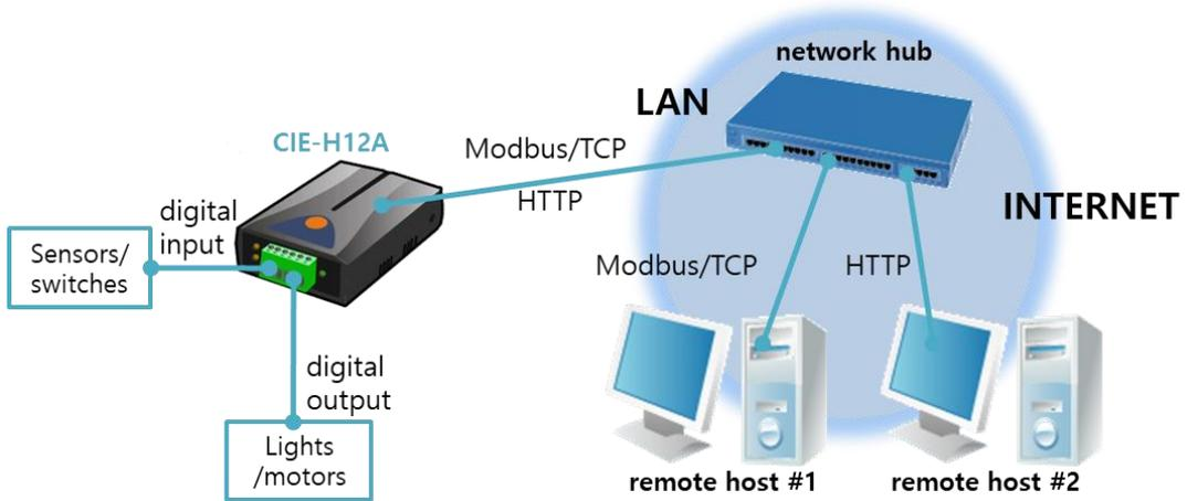
图 1-1 远程I/O设备构成 例
