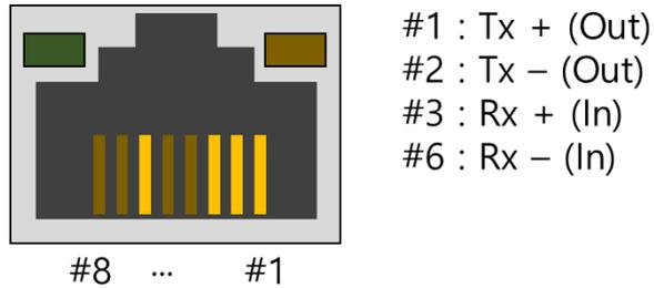
图 1-3 RJ45以太网连接器规格
