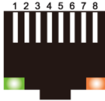
그림 1-8 RJ45 이더넷 커넥터 사양
