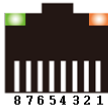
그림 1-8 RJ45 이더넷 커넥터 사양
